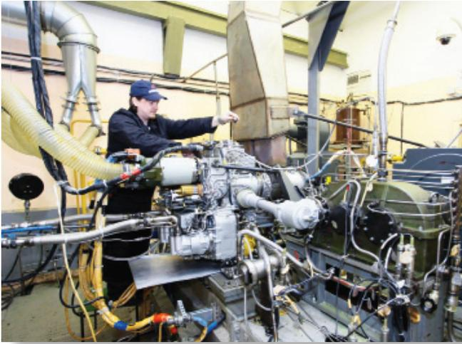
**Испытание коробки самолётных агрегатов для МиГ-29К**
